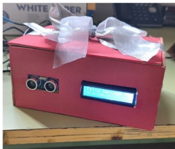
Sistema de alumbrado interactivo controlado por sensor ultrasónico
