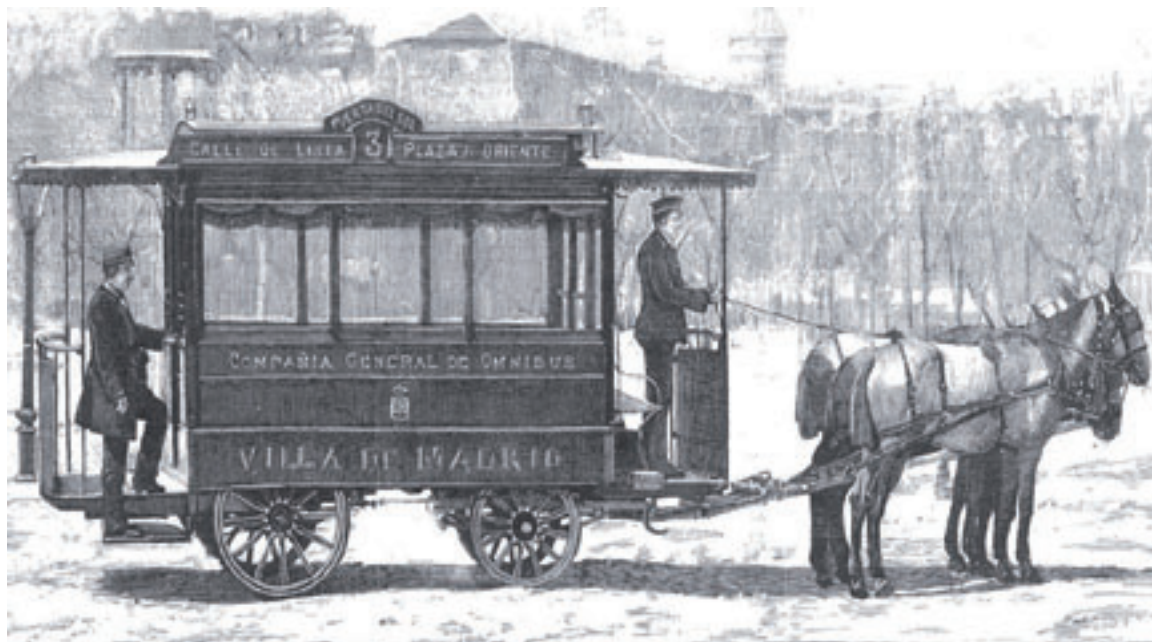
El Ripert era un ómnibus ligero cuya separación entre ruedas le permitía circular de manera abusiva por la vía tranviaria.
