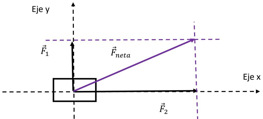
Para calcular el módulo de la fuerza neta debemos plantear el triángulo que se nos ha generado con la fuerza neta y las otras dos fuerzas en la suma gráfica.
