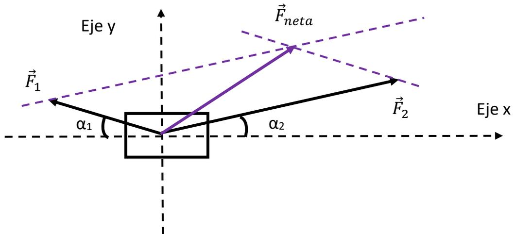
Para calcular el módulo de la fuerza neta debemos descomponer las fuerzas  $F_1$  y  $F_2$  en sus componentes  $x$  e  $y$  utilizando la trigonometría. Para ello nos darán el ángulo que forman las fuerzas con los ejes u otros ángulos que nos permitirán calcular estos. Primero voy a resolver el sistema que tenemos con letras y después sustituiré los valores de nuestras fuerzas y de los ángulos que forman las fuerzas con los ejes (que os los daré).
