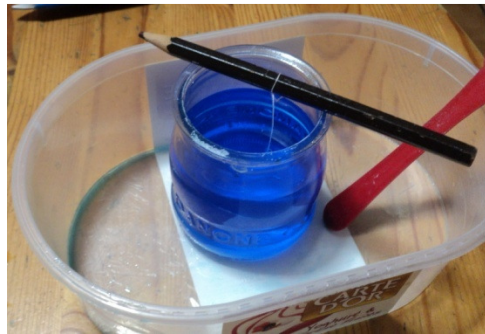
5. : Elaboración del soporte y suspensión del hilo en la solución
