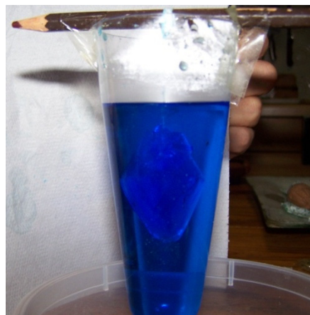
8. : Cristal obtenido tras tres ciclos de cristalización y nueva puesta en suspensión del mismo en solución saturada
