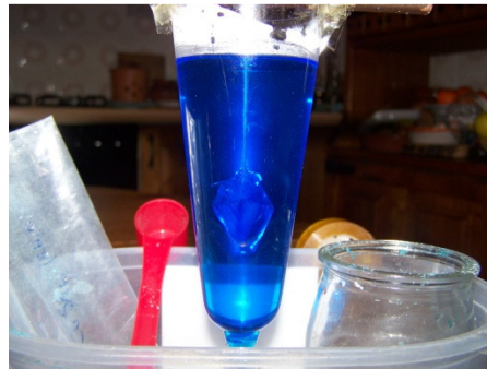
7. : Cristal obtenido tras dos ciclos de cristalización y suspensión del mismo en un recipiente alargado
