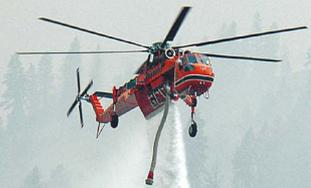
El Erickson Air-Crane S-64 es un helicóptero enorme con un depósito capaz de cargar 9.500 L de agua en 15 s y descargarlos encima del fuego en solo 3 s. Una manguera de succión permite realizar la carga sin tener que aterrizar.
