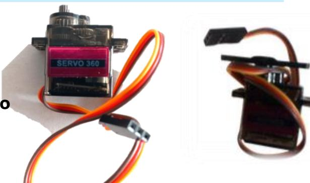
Los servomotores de 360º giran variando su velocidad en función del ángulo. De 90º a 180º va aumentando su velocidad en un sentido y de 90º a 0º va aumentando en el segundo contrario.
