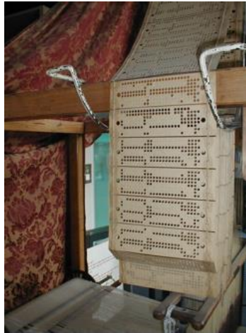
Detalle de la tarjeta perforada en el telar de Jacquard
