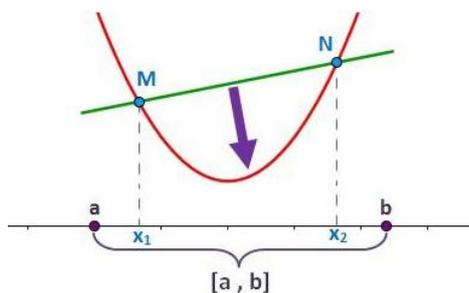
Geoméricamente la función queda por debajo del segmento que une  $f(x)$  con  $f(y)$ ,  $\forall x, y \in I$ . Una función es cóncava si se da “ $>$ ” en la desigualdad anterior.
