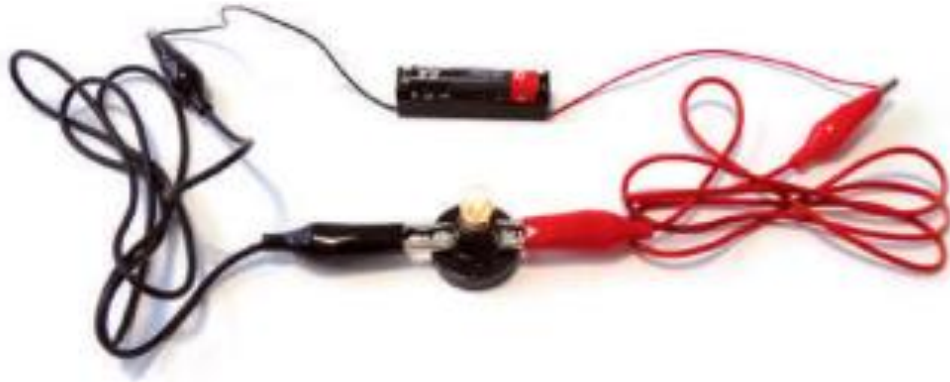
Primera imagen: Montaje para ver si funciona la bombilla
