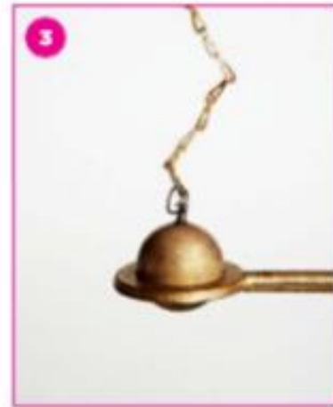
3 Observamos que la esfera caliente no atraviesa el mismo anillo.
