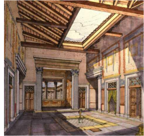
Larario, estatuillas de dioses lares y atrio con el compluvio o abertura en el tejado para la lluvia y el estanque o impluvio.
