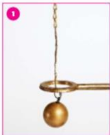
1 Comprobamos que una esfera fría pasa a través de un anillo.
