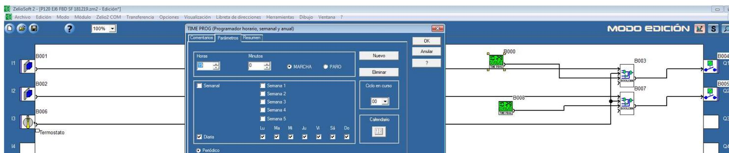
7. Monta y programa el circuito necesario para controlar tres motores de persiana de forma individual y centralizada mediante relé programable. Se debe prever que las persianas 2 y 3 se deben bajar automáticamente a las 11 de la noche.
