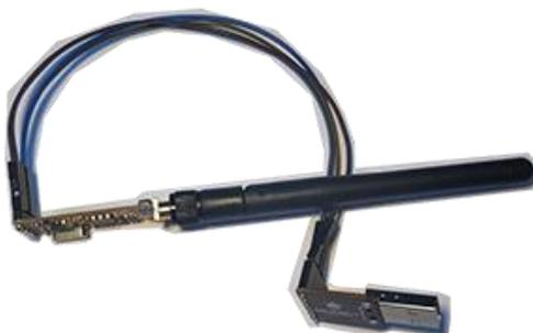
**Imagen 3:** Antena Receptora con Módulo APC220 y Conversor USB-to-Serial
