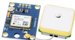
**Imagen 4:** Sensor GPS GY-GPS6MV2 NEO6MV2
