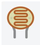
Para poder usar la LDR debemos conectarla con una resistencia o potenciómetro
