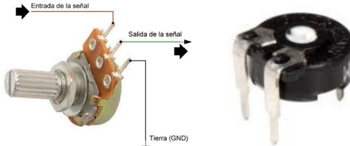
Usaremos este potenciómetro que ofrece TINKERCAD
